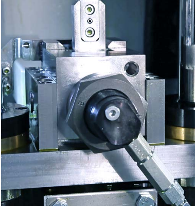
Bild: Hydraulisches Spannsystem für die Messerstange
