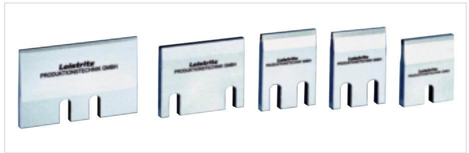
Auf speziellen Gewindewalzmaschinen wird der Werkstoff durch zwei Formrollen an den Werkstücken kaltverformt. Wie beim Spitzenlos-schleifen wird im Rollprozess eine Gewinderollauflage als abstützendes Element der Werkstücke benötigt.
