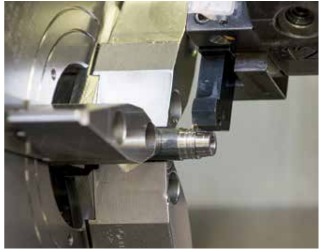
2 Das Erzeugen der Kontur aus Bild 1 mittels klassischem Formdrehprozess aus Schruppen, Schlichten und Nutstechen beansprucht je Werkstück insgesamt 8,43 s (© Leistritz)
