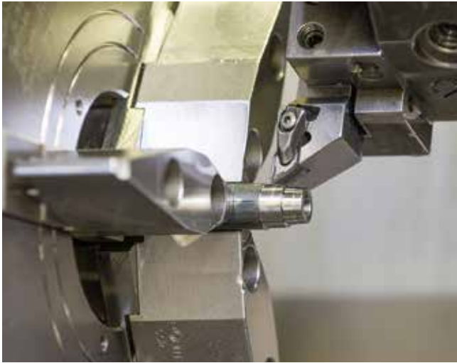
2 Das Erzeugen der Kontur aus Bild 1 mittels klassischem Formdrehprozess aus Schruppen, Schlichten und Nutstechen beansprucht je Werkstück insgesamt 8,43 s (© Leistritz)
