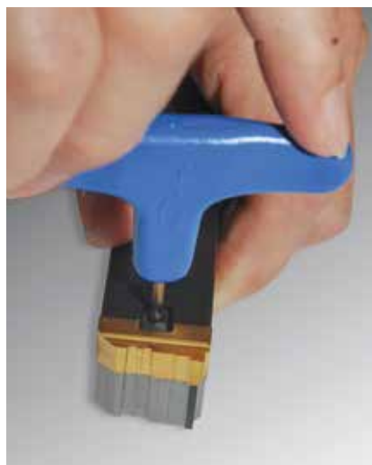
3 Eine leicht lösbare und dennoch sichere Schraubverbindung der Formstechplatte mit dem Trägerkörper ermöglicht einen schnellen Wechsel – auch innerhalb der Werkzeugmaschine (© Leistritz)
